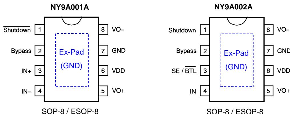
[ ]: ESOP-8 才有的外部焊墊，必須連接到PCB的接地散熱片以利散熱。
